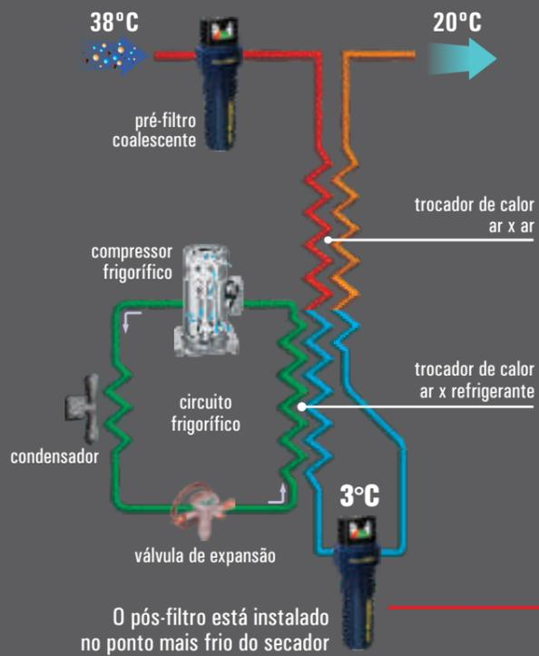
No ponto mais frio do secador por refrigeração (3°C) forma-se a maior quantidade de condensado, sendo 30% constituído por aerossóis e 70% por gotas maiores. Aerossóis são partículas líquidas (gotículas) com velocidade de queda inferior a 0,25 m/s (ISO 8573). Os aerossóis são tão leves que seu comportamento assemelha-se ao de um gás.
